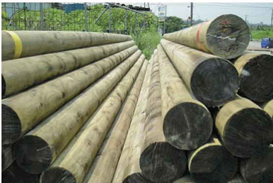
写真-1 円柱状に成形加工した木杭
