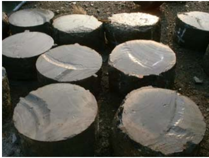
写真-7 パイル切断面・観察
