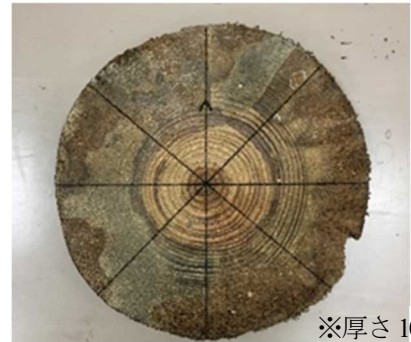
図-17 木杭の含水率測定試験体
