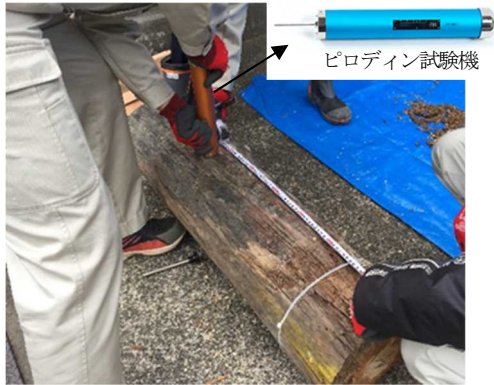
図-25 ピロディン試験状況
