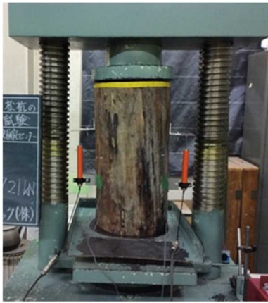
図-19 実大一軸圧縮試験状況
