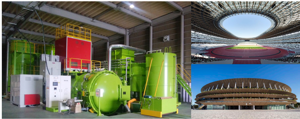
世界最大級の乾式木材保存処理装置
